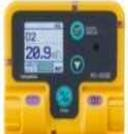
**酸素濃度**    **作業中測定 (携帯型)**    **酸欠防止**
