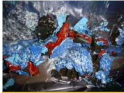
除去塗膜の回収状態
