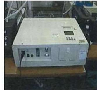
図-36 繊維状粒子自動計測器の例
